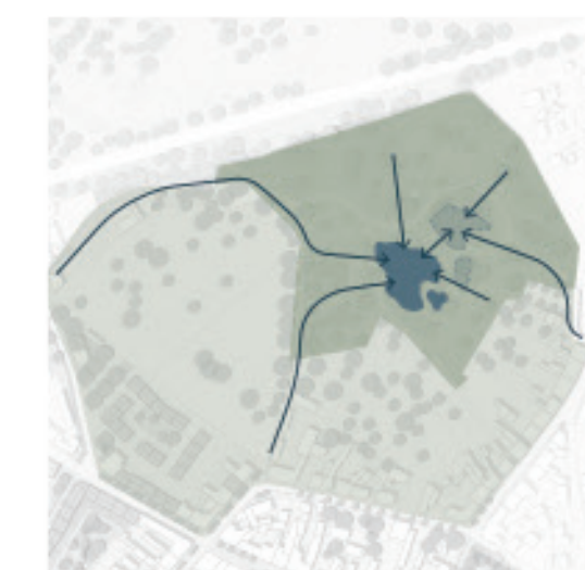
Nowe i projektowane stawy oraz system retencji
